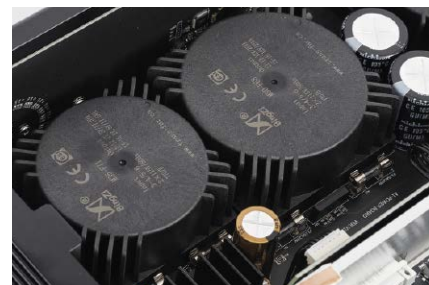
Zasilanie jest liniowe, wykorzystuje aż cztery transformatory toroidalne.
