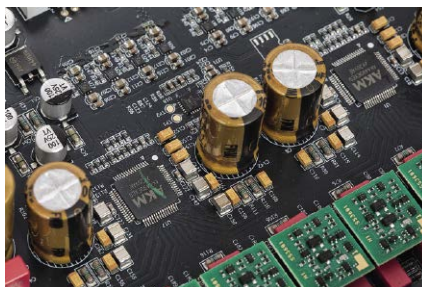
Sekcja przetworników cyfrowo-analogowych składa się z czterech stereofonicznych AKM AK4499EX (dwa na kanał).
