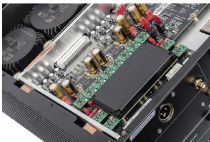
W górnej komorze, znajdują się trzy płytki; dwie identyczne to w zasadzie kompletne tory audio obydwu kanałów.
