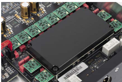
Czarna osłona, tuż przy analogowych gniazdach wyjściowych, ekranuje układy regulacji głośności.
